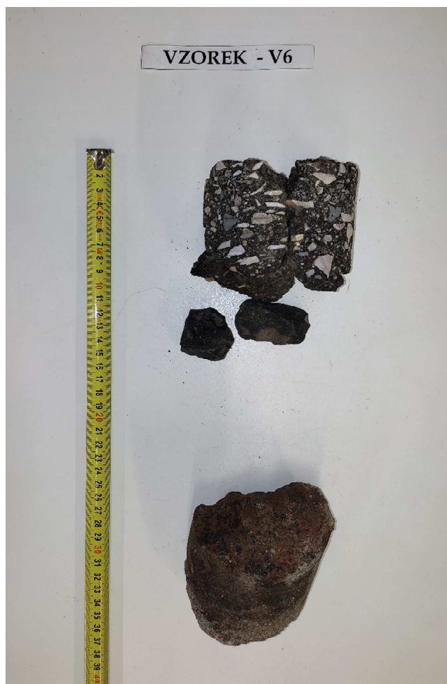
Obr. 17 - Jádro vývrtu Vzorek – V6 (laboratoř).
