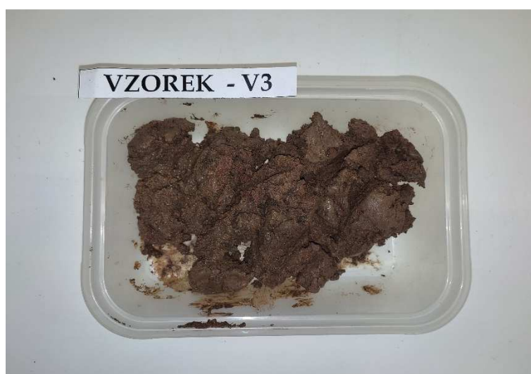
Obr. 9 – Podloží vývrtu Vzorek – V3 (laboratoř).
