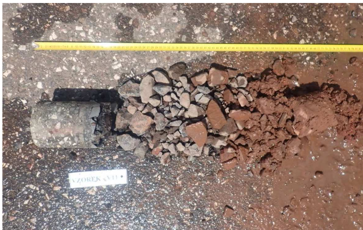
Obr. 31 - Jádro vývrtu Vzorek – V11 (in situ).
