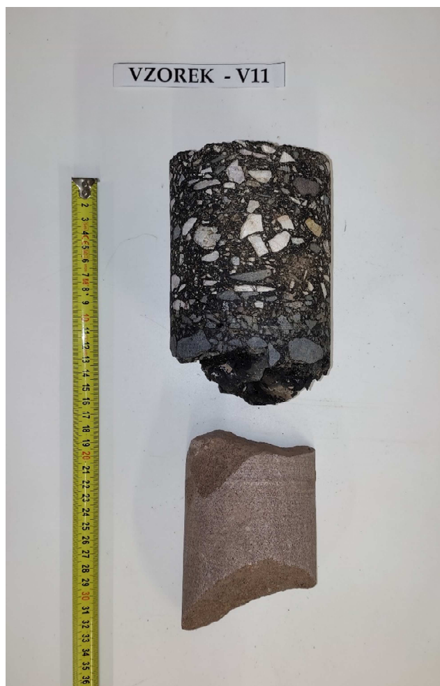
Obr. 32 - Jádro vývrtu Vzorek – V11 (laboratoř).
