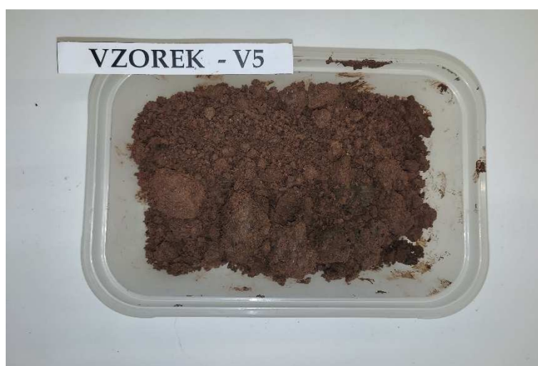
Obr. 15 – Podloží vývrtu Vzorek – V5 (laboratoř).
