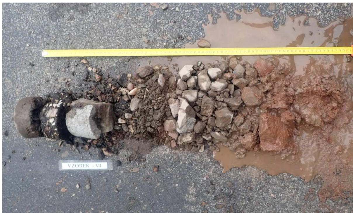
Obr. 1 - Jádro vývrtu Vzorek – V1 (in situ).
