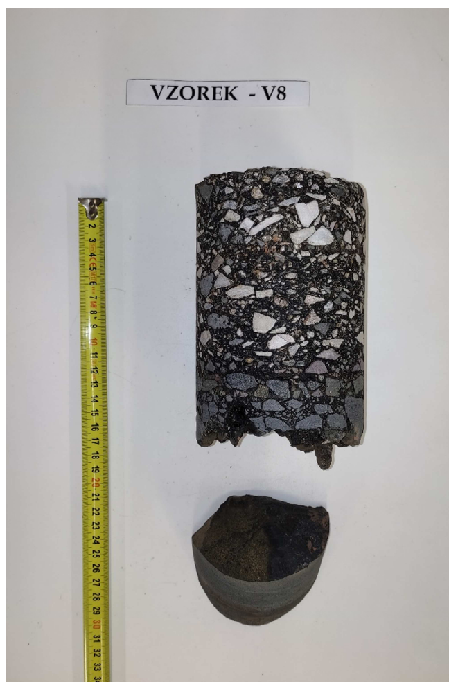
Obr. 23 - Jádro vývrtu Vzorek – V8 (laboratoř).
