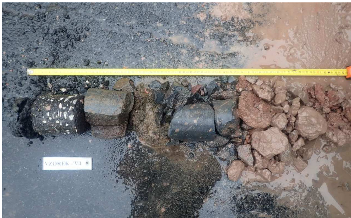
Obr. 10 - Jádro vývrtu Vzorek – V4 (in situ).
