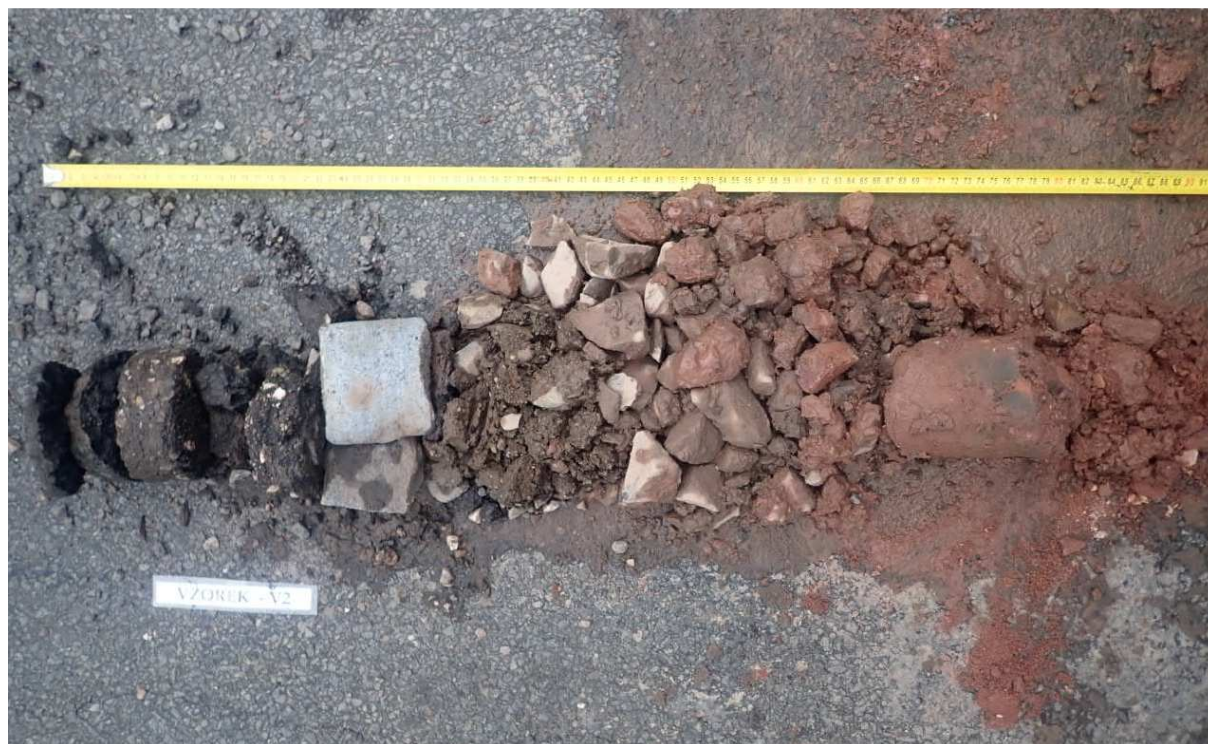
Obr. 4 - Jádru vývrtu Vzorek – V2 (in situ).
