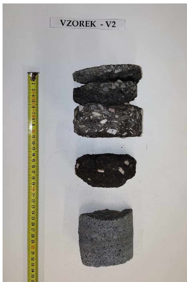
Obr. 5 - Jádro vývrtu Vzorek – V2 (laboratoř).
