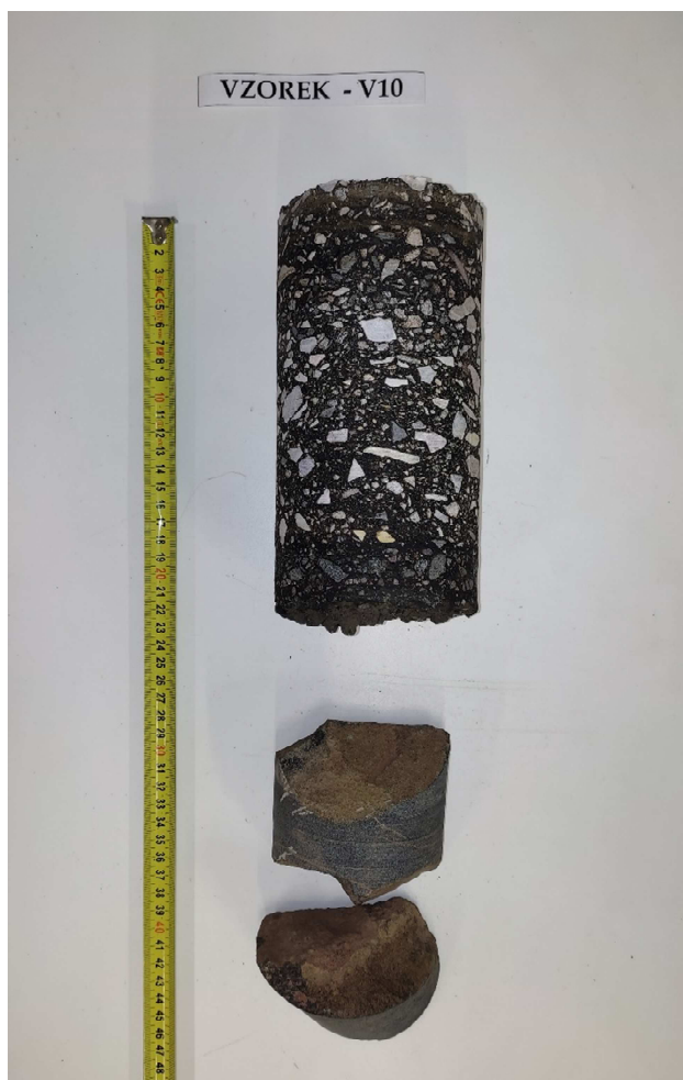
Obr. 29 - Jádro vývrtu Vzorek – V10 (laboratoř).
