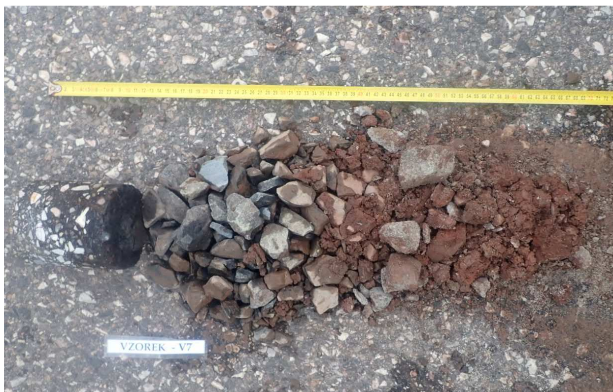
Obr. 19 - Jádru vývrtu Vzorek – V7 (in situ).
