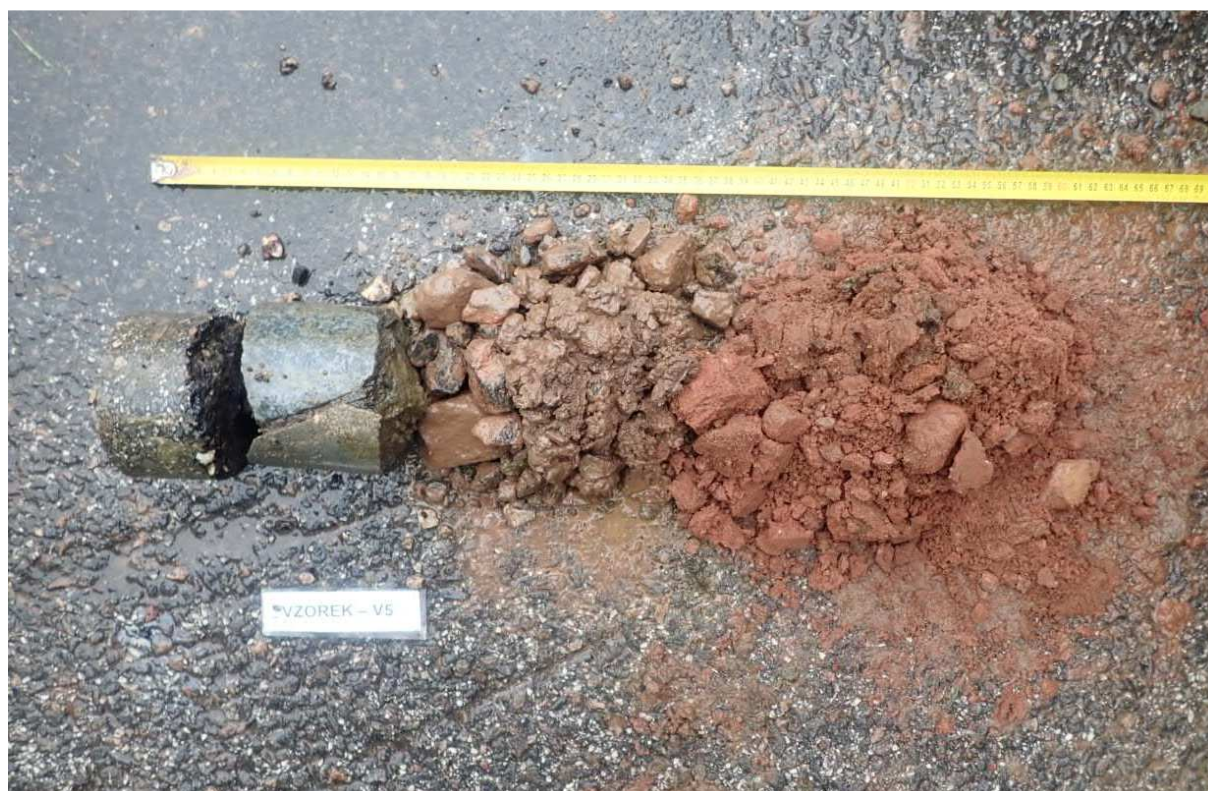
Obr. 13 - Jádru vývrtu Vzorek – V5 (in situ).
