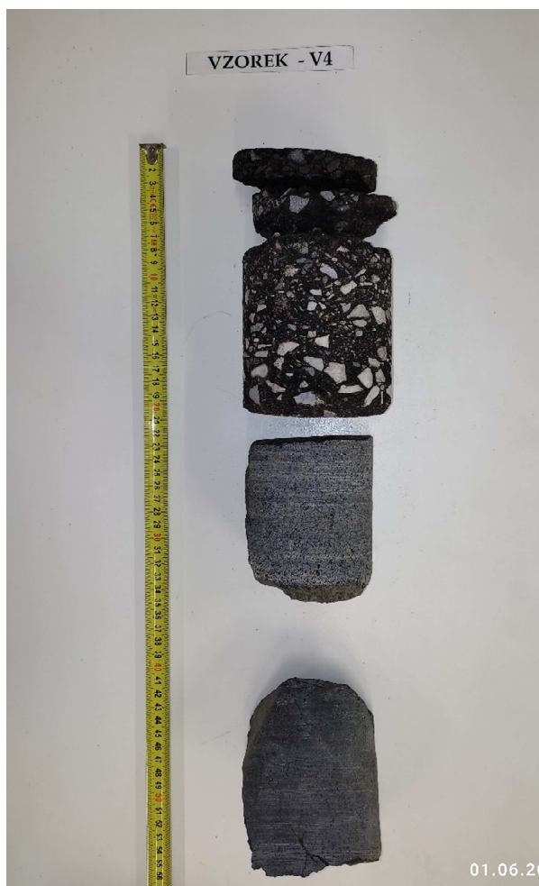
Obr. 11 - Jádro vývrtu Vzorek – V4 (laboratoř).
