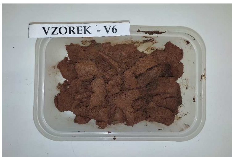
Obr. 18 – Podloží vývrtu Vzorek – V6 (laboratoř).
