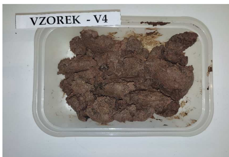
Obr. 12 – Podloží vývrtu Vzorek – V4 (laboratoř).
